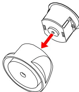
2. Coloque el conjunto del desprendedor en el orificio del mostrador. Inserte el tornillo con la arandela grande en el desprendedor por debajo del mostrador. Apriete el tornillo para fijar el desprendedor.
