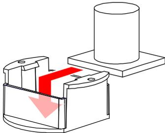
4. Sin separar el conjunto del desprendedor de la cubierta, gire la unidad y fíjela con los dos tornillos (M3x10) incluidos.
