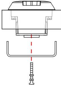
2. Retire el conjunto del desprendedor del orificio del mostrador.
