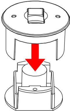
Nota: Si el conjunto del desprendedor se desmonta, coloque la tuerca en la abertura de la parte inferior, a continuación, deslice el imán en su posición desde un lado.
