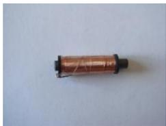
El elemento activo (Bobina) de la etiqueta Shell está fabricado en cobre, para que su funcionamiento sea de máxima fiabilidad. Este motivo es el que marca la gran diferencia entre una buena etiqueta y una mala etiqueta, las cuales están fabricadas con aluminio.
